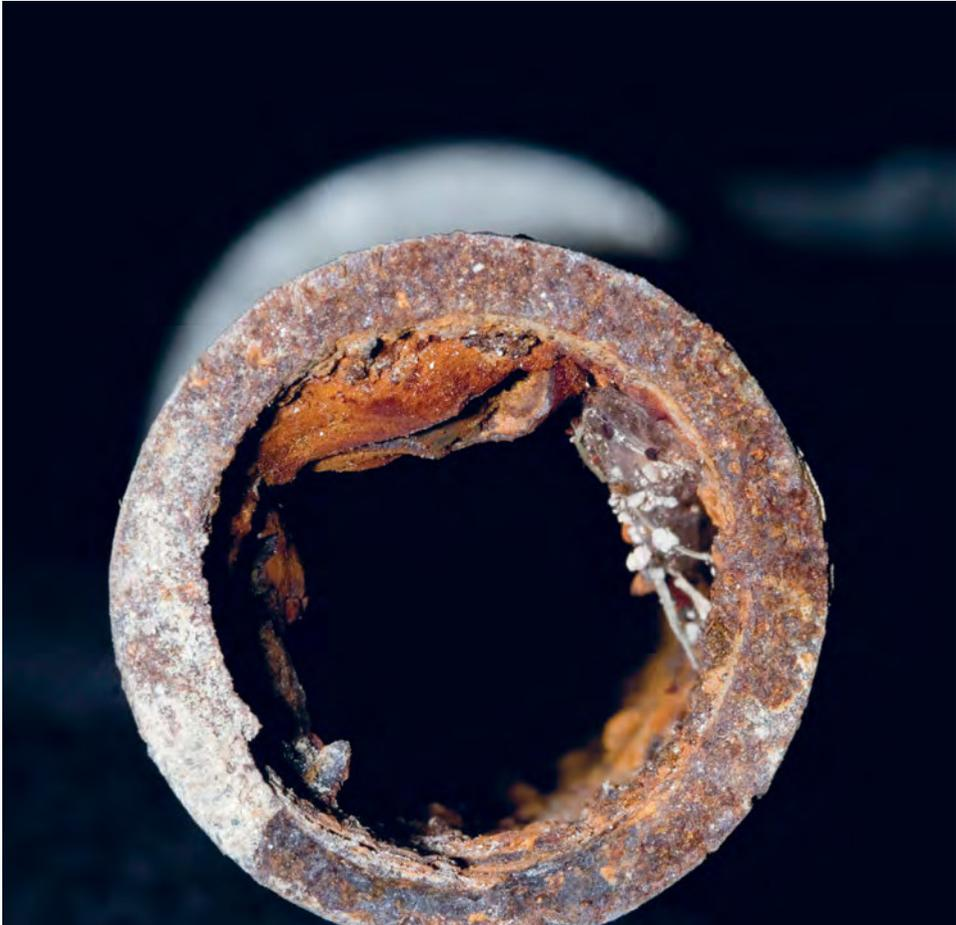
Die stürmische Entwicklung der Stahlindustrie im 19. Jahrhundert ermöglichte zunehmend die Verwendung von Stahlrohren zur Fortleitung von Wasser. Leider führt die Korrosion von ungeschütztem Stahl durch Wasser allmählich zu braunem, unappetitlichem Trinkwasser durch oxidierte Eisenverbindungen. Deshalb überzieht man sie bald mit Zink zu den besser geschützten verzinkten Stahlrohren. Sie sind preiswert und werden deshalb noch heute im Kaltwasserbereich verwendet.
